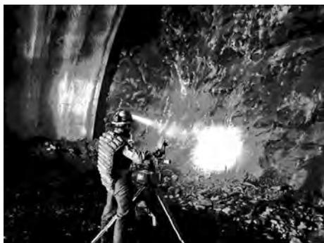
写真-1 高速3Dスキャナによる計測
