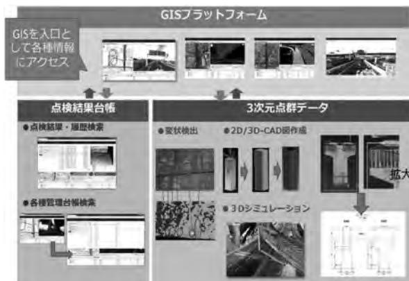
図-2 InfraDoctorシステム概要図
