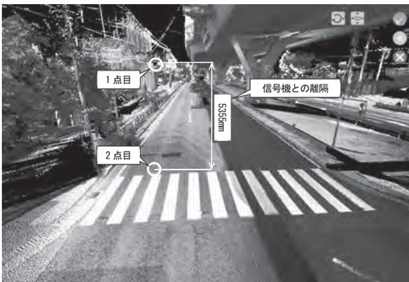
図一7 3D 寸法計測 (高さ)
