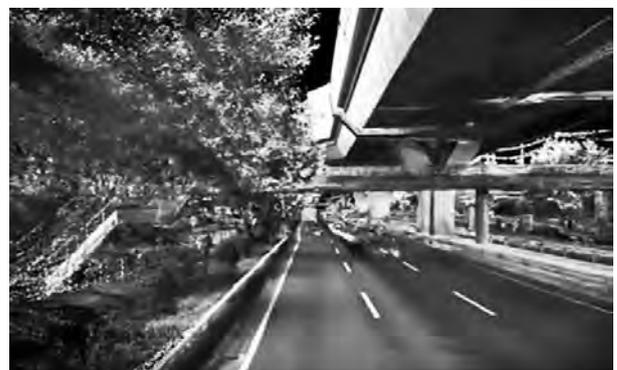
図-5 MMSで取得した点群データ
