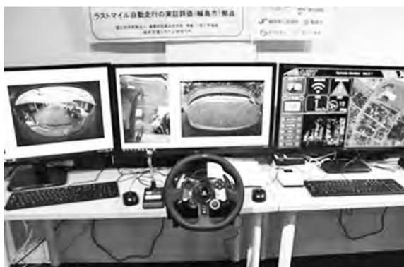
写真—3 遠隔監視・操作装置
