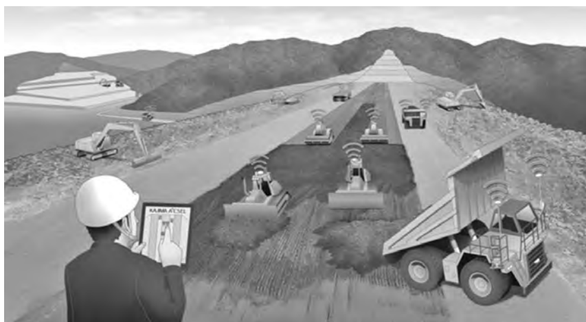
ロックフィルダム堤体工事での A 4 CSEL 稼働イメージ
