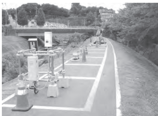
写真一 2 危機管理型水位計実証実験現地写真
