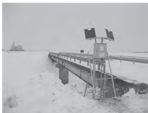
写真一 2 危機管理型水位計実証実験現地写真
