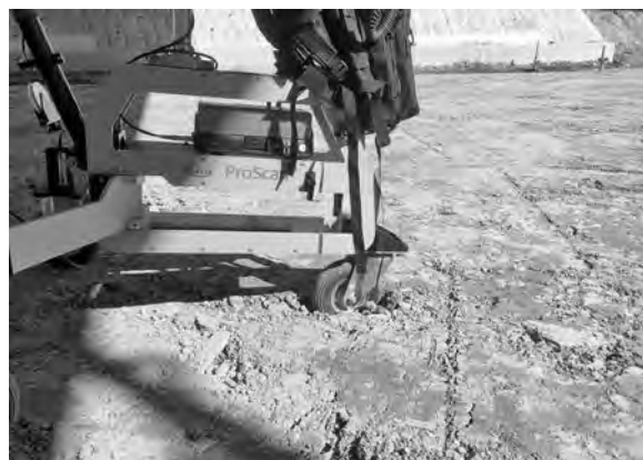
写真一3 計測中の脱輪
