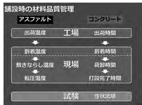
図-1 舗設材料の品質管理
