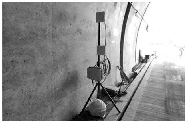
写真-4 可搬型屋外設置用 Wi-Fi 装置
