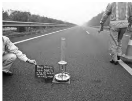
写真一八 現場透水試験
