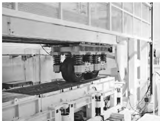
写真—1 輪荷重走行試験機
