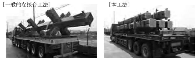
写真-2 一般的な接合法と本工法による接合部の運搬例
