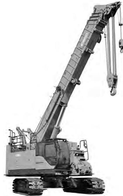
写真一 5 コベルコ建機 TK550G テレスコピッククローラクレーン
