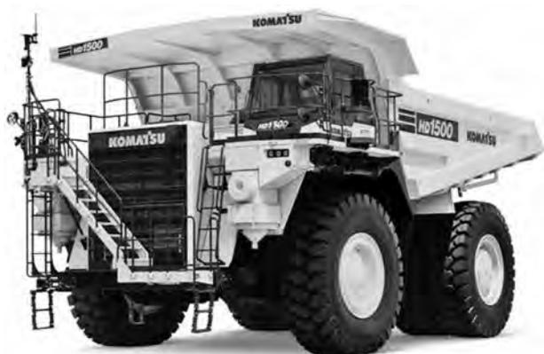
写真一 2 コマツ HD1500-8 オフロードダンプトラック
