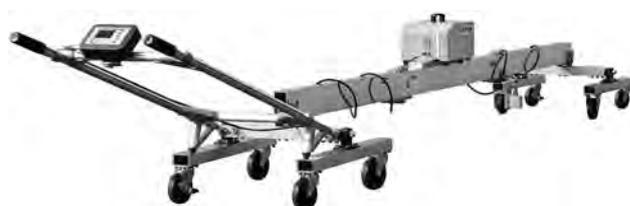
写真一七 東京計器 LP-3000 レーザ・プロファイラ
