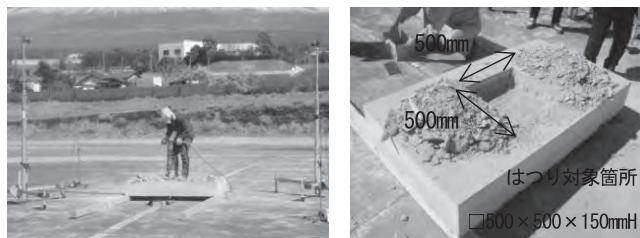
写真-2 はつり作業時間、騒音、振動計測
