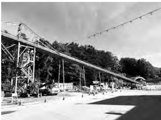
写真二 坑外ベルトコンベヤ(90m)
