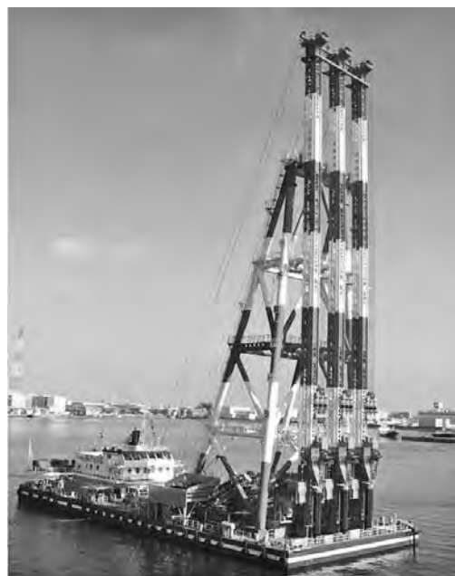
写真一六 不動テトラ ばいおにあ第30 フドウ丸 サンドコンパクション船
