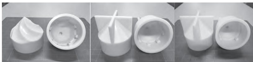
写真一2 開発した捨てビット（左：スクリュウ型、中央：十字型、右：改良十字型）
