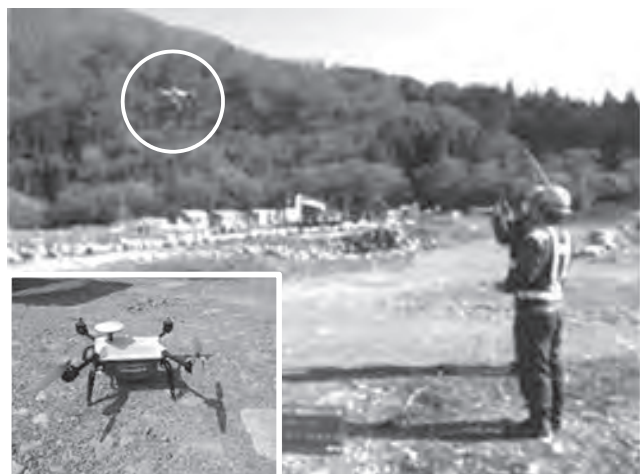
写真—1 UAV による 3 次元測量
