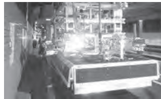
アウトリガーによる研掃装置の水平設置
