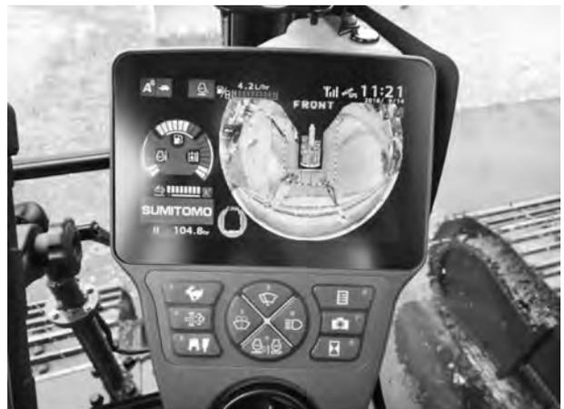
写真-3 カメラの合成映像
