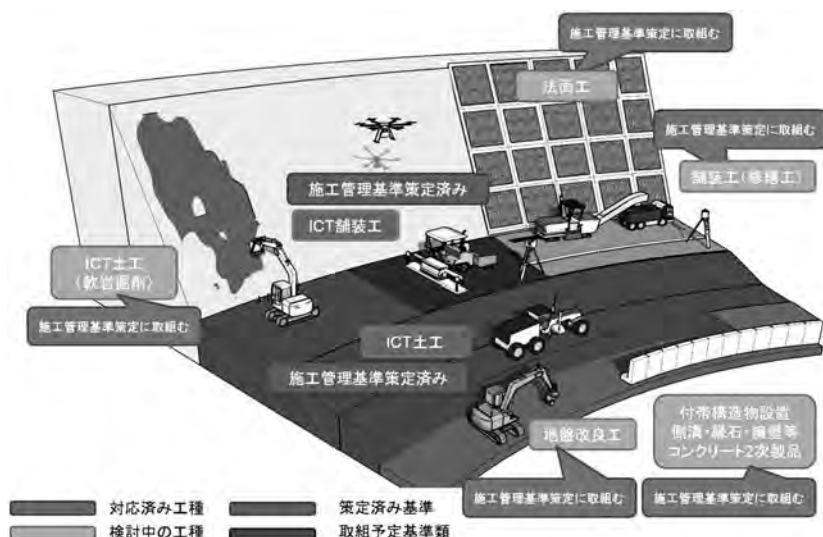
図—2 ICT の全面的活用を実現する工種拡大イメージ（道路工事の例）
