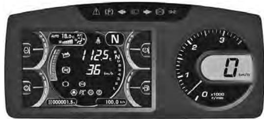
図一九 高精細 7 インチ LCD ユニット付き機械モニタ
