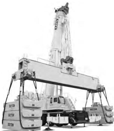
写真-2 最大過荷重試験姿勢例
