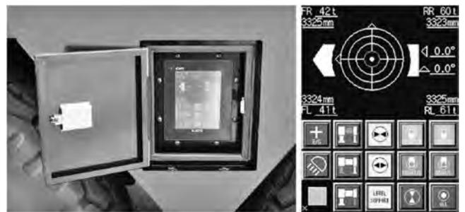
写真一 12 アウトリガ操作パネルと表示例
