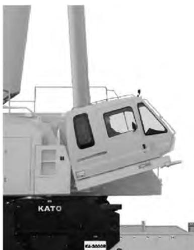
写真—4 チルト式クレーン運転室
