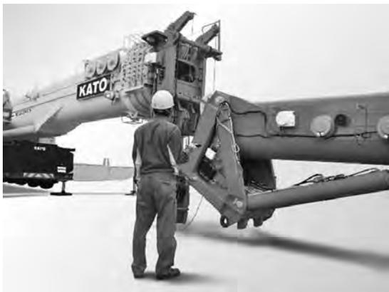
写真-3 SLジブ自力着脱作業例
