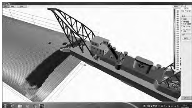
図一2 3次元施工管理システム
