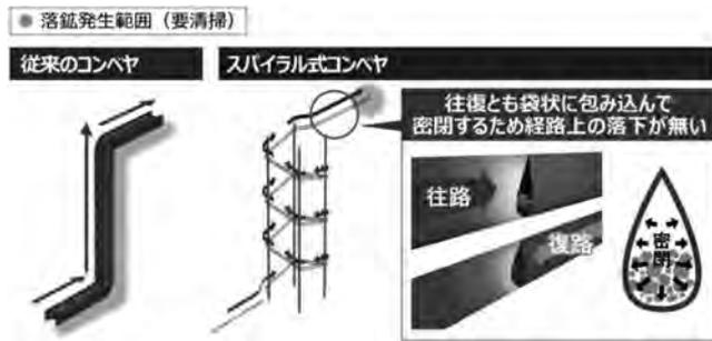
図-7 落鉱(落石)の削減
