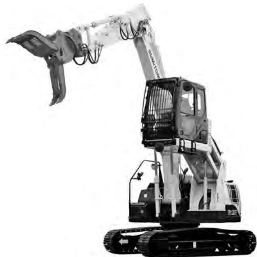
写真一 2 住友建機 SH120LC-7MH 油圧ショベル
