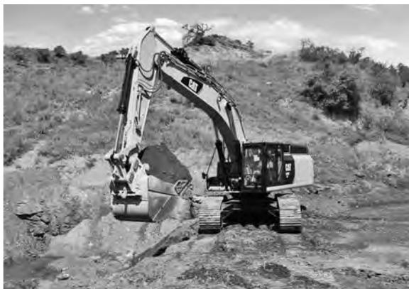
写真一 1 キャタピラージャパン Cat349FL XE 油圧ショベル
