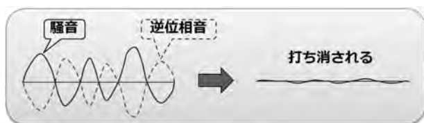
図一2 本装置の原理
