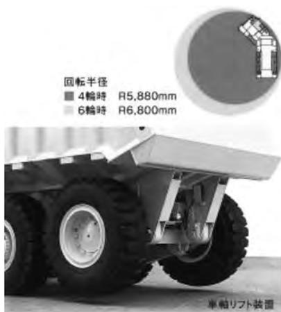
図-3 車輪リフト装置
