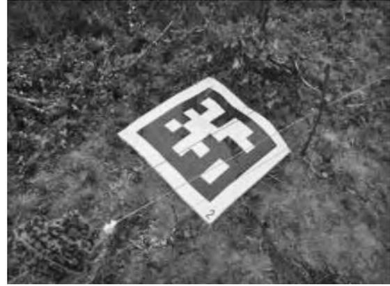
写真三 UAV 写真測量に用いた基準点 (GCP)
