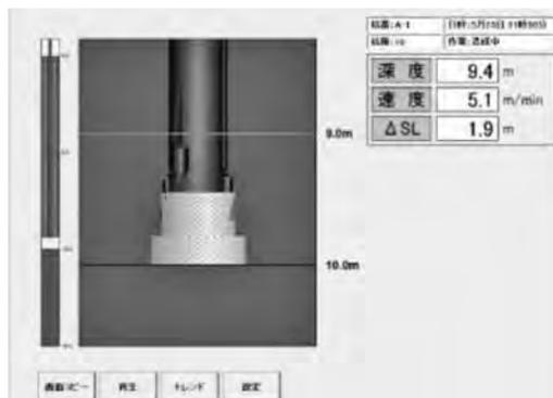
図-3 新しい施工管理計器画面(左: 機械攪拌式深層混合処理工法, 右: 砂杭系工法)
