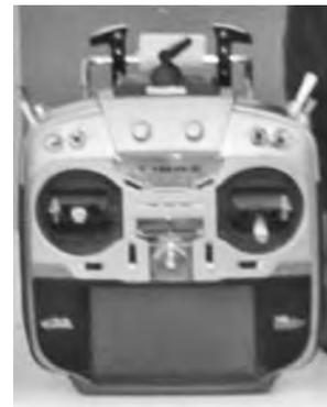
図—3 プログラマブル18CH RC 操縦送信機
