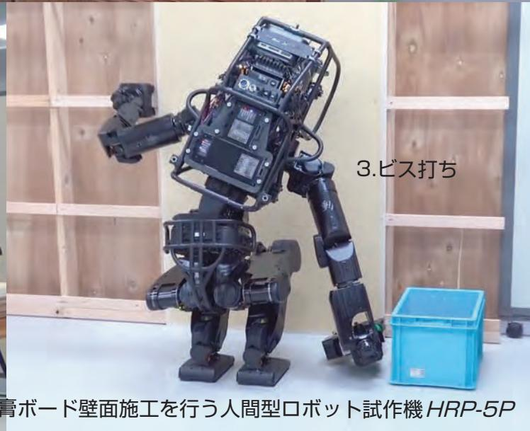
石膏ボード壁面施工を行う人間型ロボット試作機 HRP-5P
