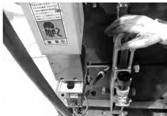
写真二2 仮固定治具の回避溶接機構
