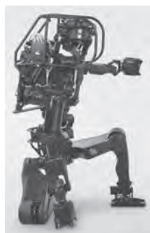
図一六 多自由度化、可動範囲拡大による人動作模擬能力の拡大
