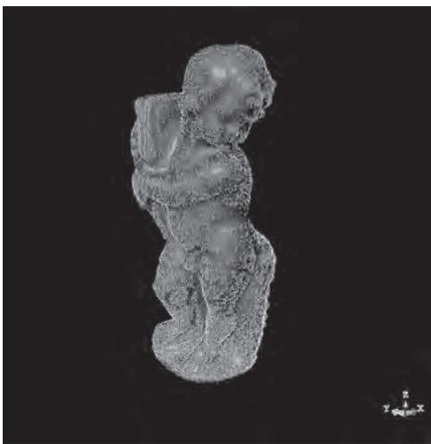
図-3 点群を直接モデル化したモニュメント
