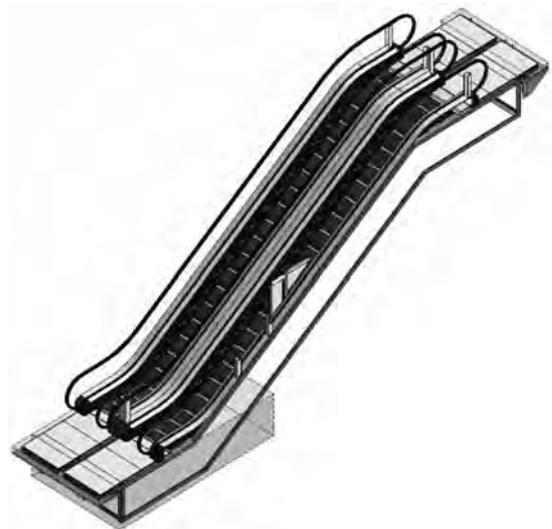
図-6 エスカレーターの BIM モデル
