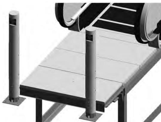
図一七 光電装置の BIM モデル
