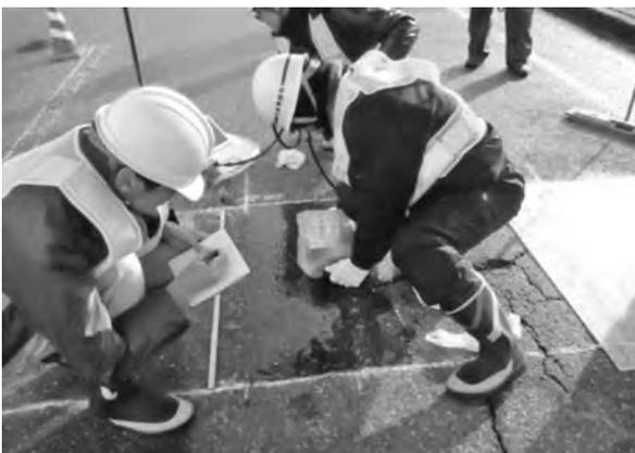
写真一八 超音波計測
