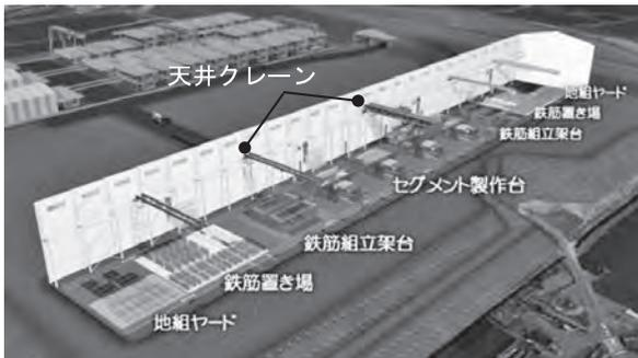
図一七 セグメント製作設備内部
