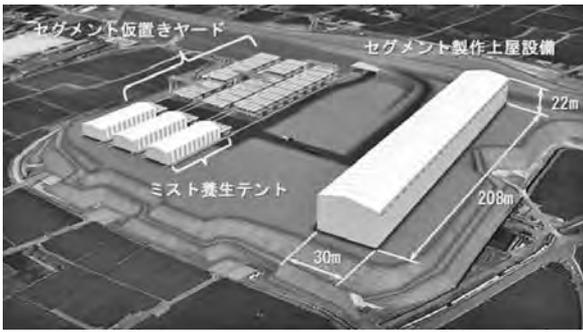
図一六 セグメント製作・仮置き設備全景
