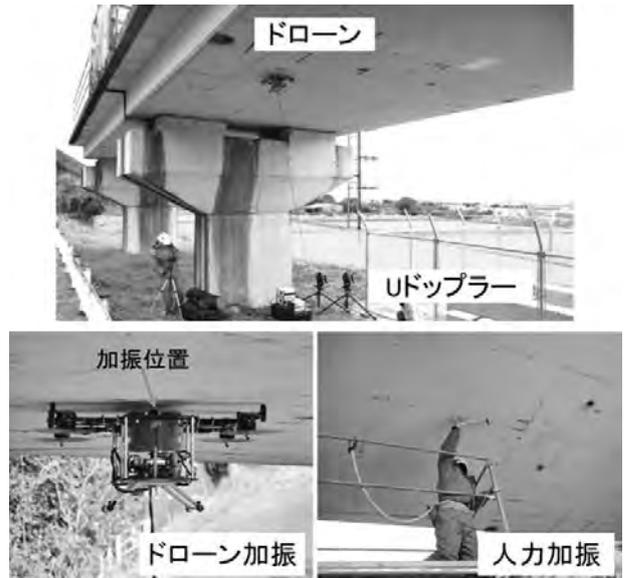
写真一6 弾性波の測定・加振状況
