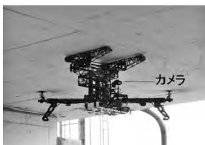
写真一4 桁下面の撮影状況
