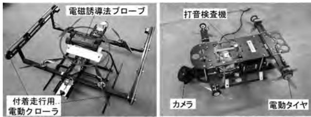
写真一2 開発した付着走行ドローン例
