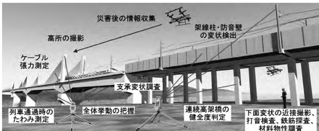
図-1 鉄道橋健全度の遠隔非接触評価手法
