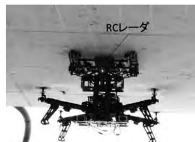
写真一5 内部鉄筋のレーダ探査状況
