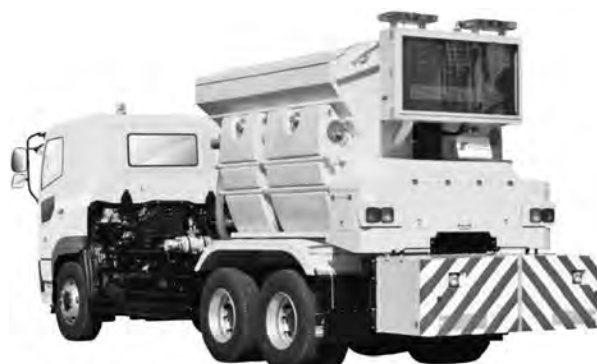
写真—2 極東開発工業 ES05-10 湿塩散布車
