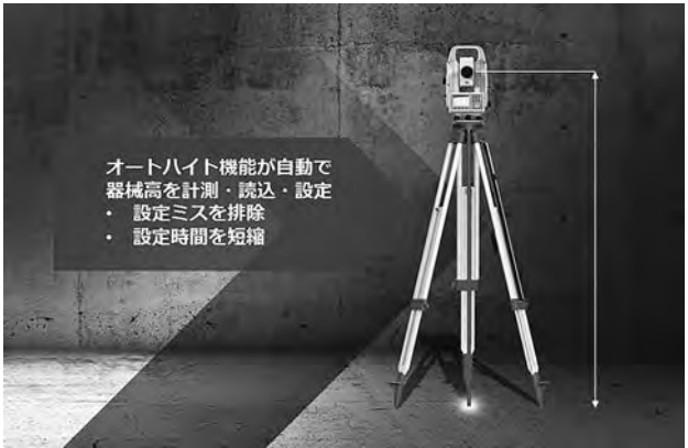
写真-5 ワンボタンで器械高を計測し設定
