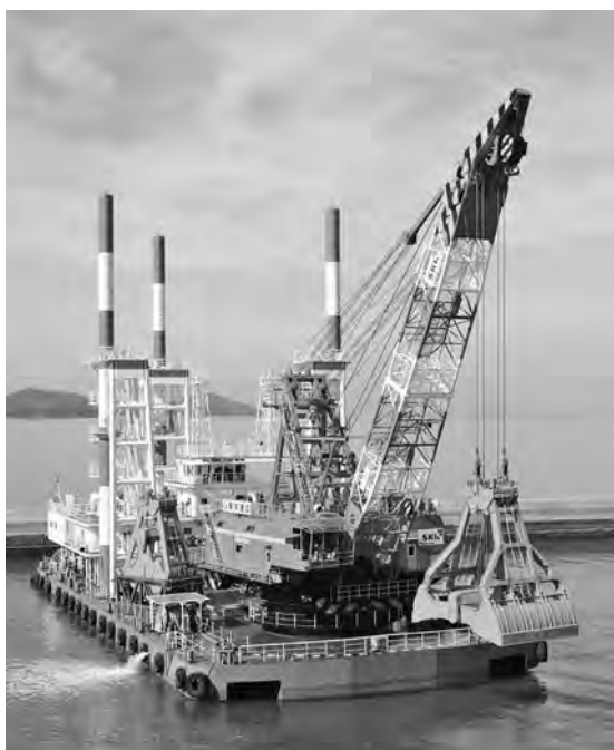
写真一 3 東洋建設、タチバナ工業 拓海 非自航グラブ浚渫船兼起重機船
