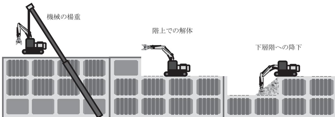
図-1 階上解体工法のイメージ
