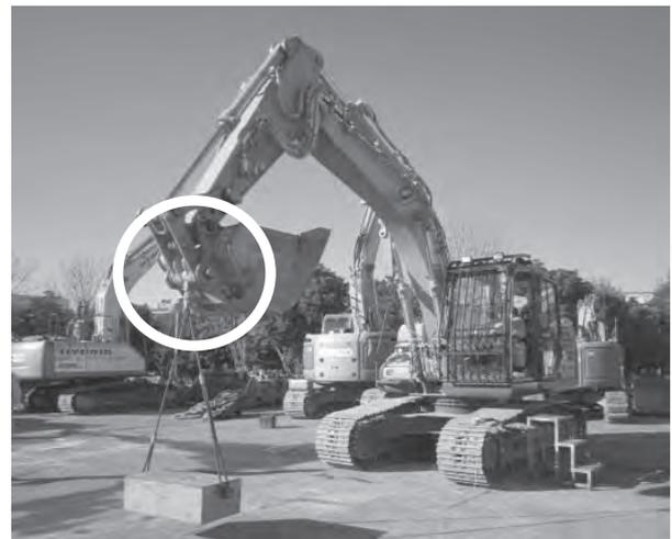
写真—5 クレーン機能の搭載
