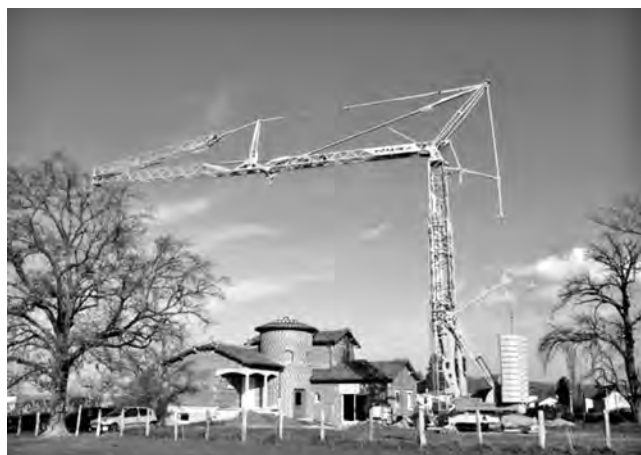
写真二 Manitowoc POTAIN 製 Igo T-70A (1.3t-40m)
