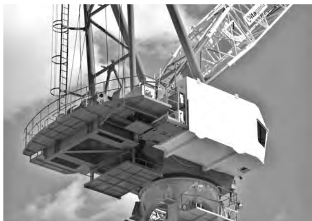
写真一 株北川鉄工所製 JCL1000NK (最大 34.2t 吊り)
