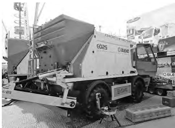
写真-18 移動式練混ぜプラント (BLEND)
