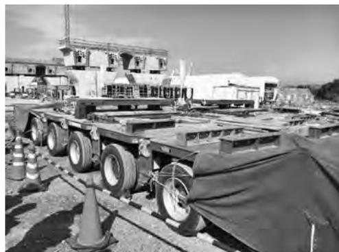
写真一7 自走式多軸台車
