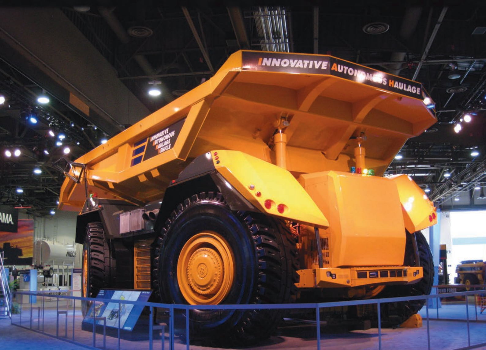
新コンセプトのキャブレス無人ダンプ車両 (2016年の米国展示会における実機展示の様子)
