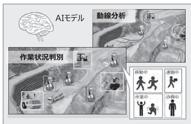
図—3 AIによる建機・作業員の作業判別
