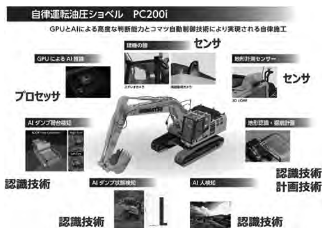
図—6 自律運転油圧ショベルの搭載機能
