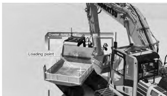
図—4 クローラダンプ検知
