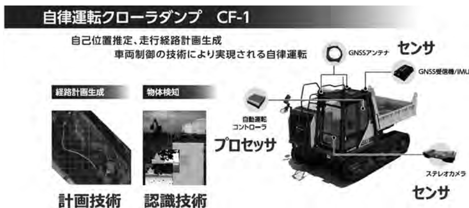
図—8 自律運転クローラダンプの搭載機能
