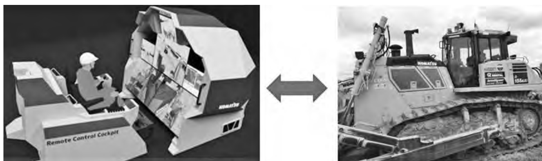
図—9 遠隔操作による敷き均し作業イメージ
