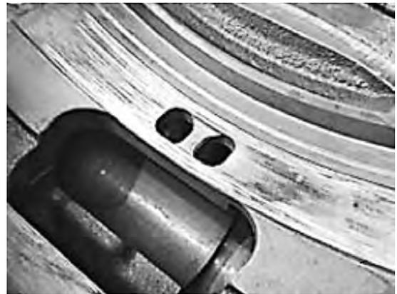
写真—1 損傷を受けた油圧ポンプの内部部品
