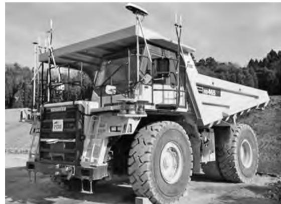
写真一3 自律自動化ダンプトラックの全景
