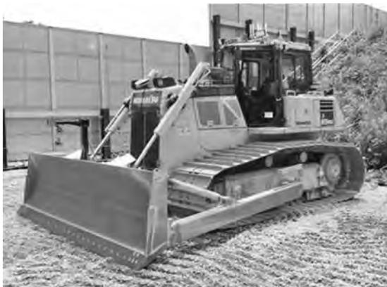
写真一2 自律自動化ブルドーザの全景
