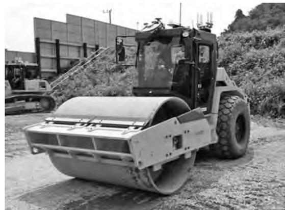
写真一1 自律自動化振動ローラ全景
