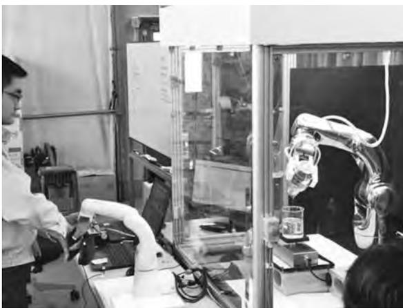
写真一四 遠隔操作による滴下動作の教師データ取得
