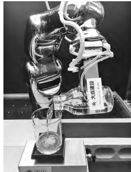
写真一五 AIによる自律計量動作
