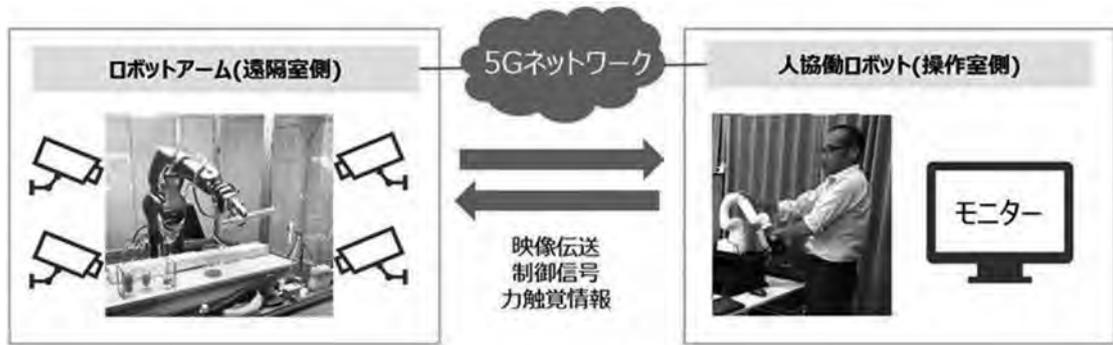
遠隔操作検証実験概要図
