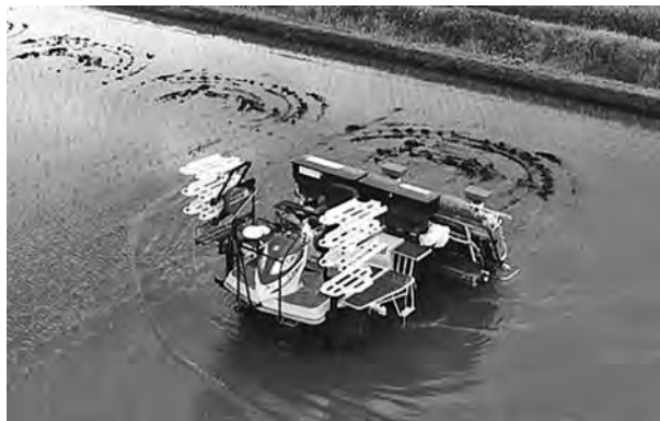
写真—2 無人作業中の自動運転田植機 ※出典：井関農機㈱webサイトより
