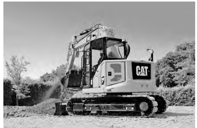
写真ー2 キャタピラージャパン Cat 308 CR 後方超小旋回型油圧ショベル
